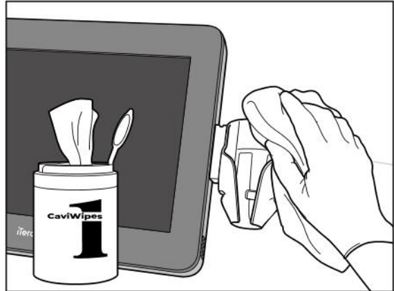
Şekil 208: iTero Element 2 Plus mobil konfigürasyonuna sahip sistemin tutucu yuvasının silinmesi
